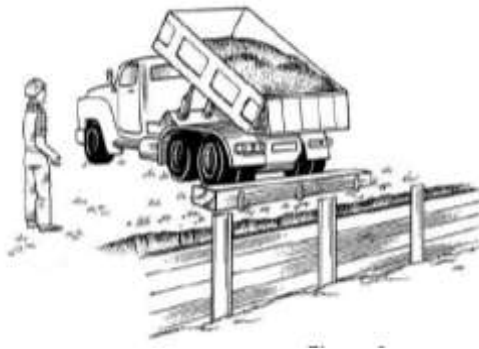
Figura 3: Bloques de tope para impedir que los camiones volquetas se deslicen dentro de la excavación al descargar en marcha atrás.
