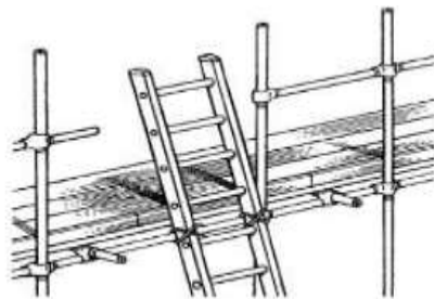
Figura 7: Escalera amarrada por el cabezal y sobresaliendo por encima del lugar de acceso.
