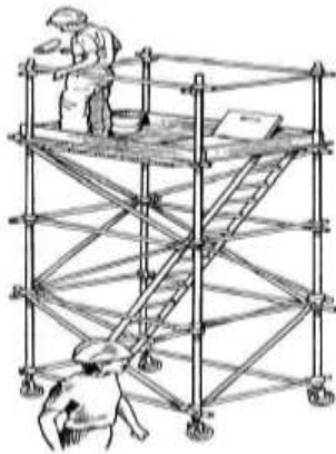
Figura 5: Andamio móvil de torre: las ruedas deben estar trabadas cuando no se usa y la escalera de acceso debe estar dentro de la torre.
