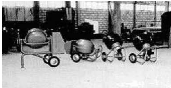
Figura 8: Diferentes tipos de concreteras móviles. Está compuesta de un chasis y un recipiente cilíndrico que se hace girar con la fuerza transmitida por un motor eléctrico o de gasolina.
