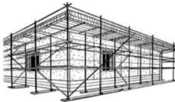
Figura 4: Andamio independiente amarrado, que no se apoya en el edificio. Tiene una hilera interna y otra externa de postes que lo sostienen.
